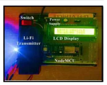
Fig. 6 Transmitter module
